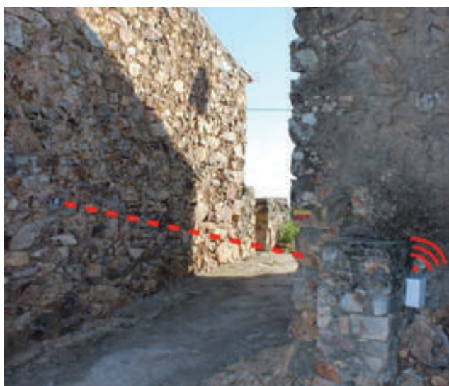
Local de testes, em Penha Garcia, com sensor físico e módulo de comunicações 3G (caixa branca).
