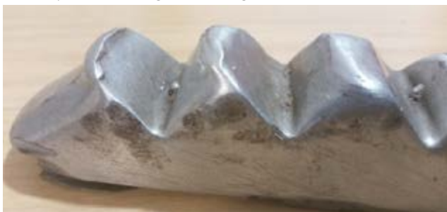
Figura 3 - Macrografia da superfície do dente do tipo 2
